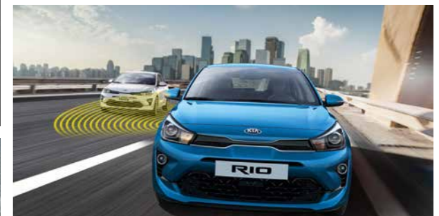
Der Spurwechselassistent ^ mit Totwinkelwarner ^ (Blind-Spot Collision Warning, BCW) erkennt mit Radarsensoren an den Seiten und am Heck herannahende Fahrzeuge im Bereich des toten Winkels und warnt den Fahrer bei Bedarf davor, die Fahrspur zu wechseln. Sollte er es dennoch versuchen, erfolgt bei den Ausführungen mit DCT-Getriebe automatisch ein Lenk- und Bremsingriff, um eine Kollision zu vermeiden.
