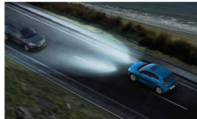
Der Fernlichtassistent ^ (High Beam Assist, HBA) erkennt bei Dunkelheit per Kamera entgegenkommende und vorausfahrende Fahrzeuge, blendet automatisch ab und – sobald es möglich ist – wieder auf.
