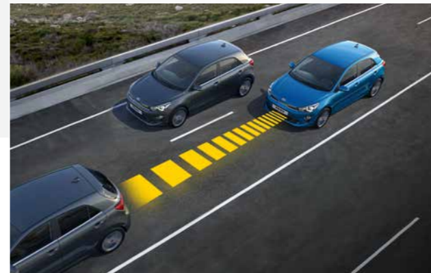
Die adaptive Geschwindigkeitsregelanlage ^ (Smart Cruise Control, SCC) misst per Kamera und Radar die Distanz zum vorausfahrenden Fahrzeug sowie dessen Geschwindigkeit. Wird der festgelegte Sicherheitsabstand unterschritten, bremst das System den Kia Rio ab. Sobald die Verkehrssituation es zulässt, wird das Fahrzeug wieder auf die eingestellte Geschwindigkeit beschleunigt.
